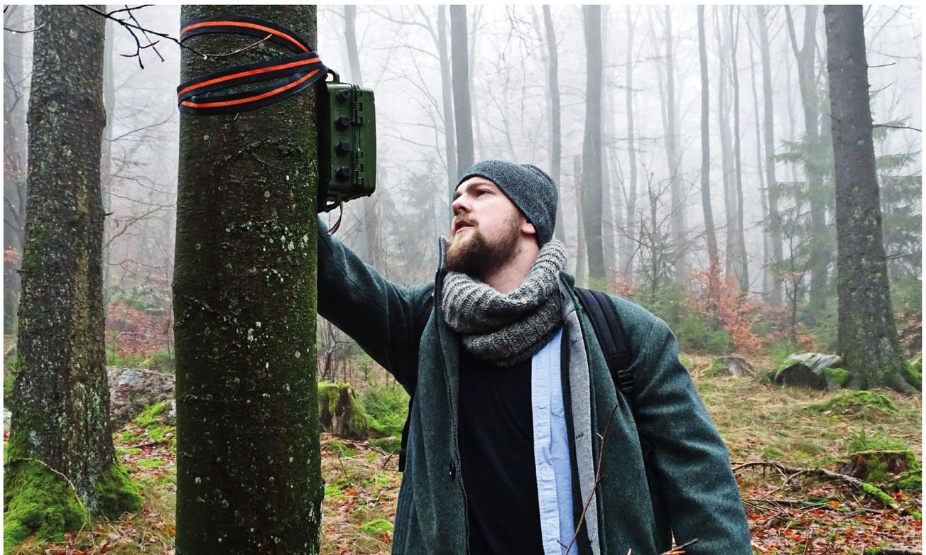
**Abbildung 1:** Ausbringung eines Songmeters
